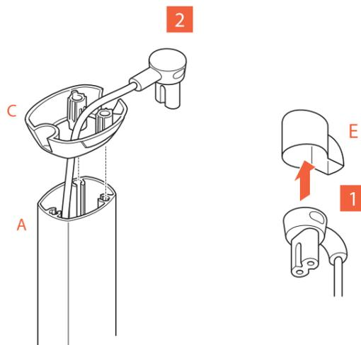
5. Entfernen Sie das **Kabelführungswerkzeug** (E) und ziehen Sie den Stecker durch die **Stangenkappe** (C) und stecken Sie das Kabel in den Schlitz auf der Rückseite der **Stangenkappe** (C).
