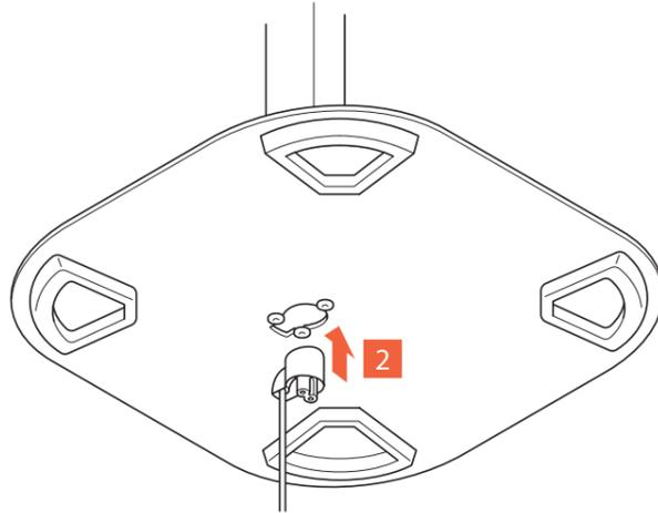
4. Schieben Sie den Stecker mit dem **Kabelführungswerkzeug** (E) in den Boden der **Bodenplatte** (B) und durch die **Stange** (A).
