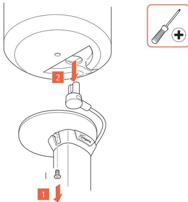
1. Schrauben Sie die **1x M5\*12-mm-Schraube** ① von der **oberen Platte** ② ab, um den Era 100-Lautsprecher zu entfernen.
