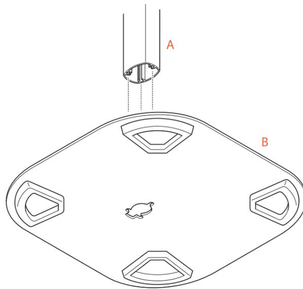
1. Legen Sie die **Stange** (A) auf die **Bodenplatte** (B).
