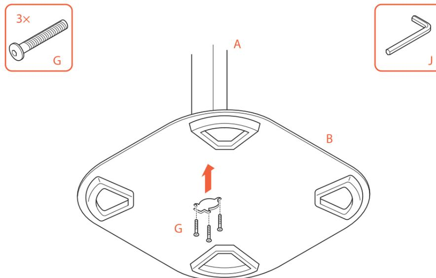
2. Befestigen Sie die **Stange** (A) mit den **3 x M5\*35-mm-Schrauben** (G) an der **Bodenplatte** (B).
