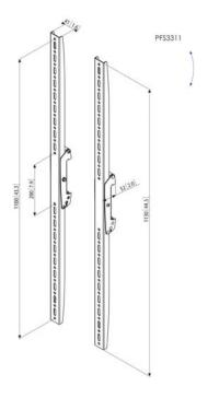
PFS 3311 ist für mittelgroße bis große Displays bis 80 kg Gewicht und einem max. vertikalen Passbereich von 1100 mm geeignet. Kombinieren Sie diese Displayadapter mit einer Connect-it Deckenkonsole (PUC 1060/ 1070/ 1080/ 1090), einem Connect-it Rohr (PUC 2508/ 2515/ 2530) und einer Connect-it Adapterleiste (PFB 3405/ 3407/ 3409/ 3411) zu einer Komplettlösung für die Deckenbefestigung.
