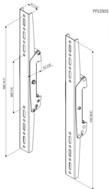
PFS 3305 ist für mittelgroße bis große Displays bis 80 kg Gewicht und einem max. vertikalen Passbereich von 500 mm geeignet. Kombinieren Sie diese Displayadapter mit einer Connect-it Deckenkonsole (PUC 1060/ 1070/ 1080/ 1090), einem Connect-it Rohr (PUC 2508/ 2515/ 2530) und einer Connect-it Adapterleiste (PFB 3405/ 3407/ 3409/ 3411) zu einer Komplettlösung für die Deckenbefestigung.
