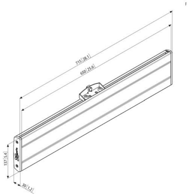
PFB 3407 ist für mittelgroße bis große Displays bis 80 kg Gewicht und einem max. horizontalen Passbereich von 650 mm geeignet. Kombinieren Sie diese Adapterleiste mit einer Connect-it Deckenkonsolle (PUC 1060 / 1070 / 1080/ 1090), einem Connect-it Rohr (PUC 2508 / 2515 / 2530) und einem Connect-it Displayadapter (PFS 3303 / 3304 / 3305 / 3306 / 3308 / 3311) zu einer Komplettlösung für die Deckenbefestigung.
